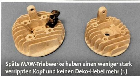
Späte MAW-Triebwerke haben einen weniger stark verrippten Kopf und keinen Deko-Hebel mehr (r.)
