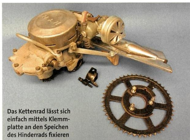
Das Kettenrad lässt sich einfach mittels Klemmplatte an den Speichen des Hinterrads fixieren
