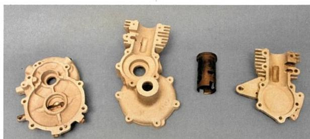
Große Besonderheit des kleinen Zweitakters: Der Zylinder ist Teil der Gehäusehälften, ebenfalls zweigeteilt und praktisch nur ein Kühlkörper...
