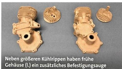
Neben größeren Kühlrippen haben frühe Gehäuse (l.) ein zusätzliches Befestigungsauge
